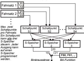
**Beispiel 1:** Im Fahrsatz 2 soll 150 mm vor der Zielposition der Binärausgang 2 (Relais 2) gesetzt und beim Erreichen der Zielposition wieder zurückgesetzt werden.
