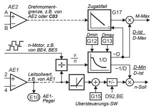
Vor dem Anfang des Wickelvorgangs muss der Anfangsdurchmesser über einen Binäreingang (z.B. **F31**=29 für BE1) auf **G14** gesetzt werden. Bei Netz-Aus wird der aktuelle Durchmesser *D-Ist* nichtflüchtig gespeichert.
