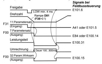
Bei aktivem Autostart (**A34**=1) erfolgt die Umschaltung sofort mit Flanke des Signals "11:Parametersatz". Die Freigabe wird in diesem Fall automatisch intern deaktiviert.
