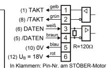
Unterstützt werden Multiturn - Geber mit 4096 Umdrehungen und 4096 bzw. 8192 Schritten pro Umdrehung (24 bzw. 25 Datenbits, einstellbar in Parameter **H62**). Der Parameter **H22** (X20-Inkremente) ist im Normalfall auf 1024 (Werkseinstellung) zu belassen. Die Taktfrequenz beträgt 250 kHz. Es können Gray- oder Binärcode im Parameter **H61** eingestellt werden.
