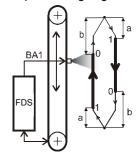
**Lösung:** Es werden zwei Fahrsätze (Position oben, Position unten) und zwei Schaltpunkte benötigt. Mit dem ersten Schaltpunkt wird der Schaltspeicher 1 ("S-Speicher 1") aktiviert, mit dem zweiten Schaltpunkt der gleiche Speicher deaktiviert:
