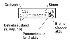
Die möglichen Betriebszustände sind im Kap. 16 aufgelistet. Beim Aufleuchten des Zeichens ■ arbeitet der Umrichter mit Parametersatz Nr.2. Ist der Parametersatz Nr. 1 aktiv (Werkseinstellung), erfolgt keine besondere Anzeige. Das Zeichen <sup>B</sup>c erscheint bei Aktivierung des Bremschoppers.
