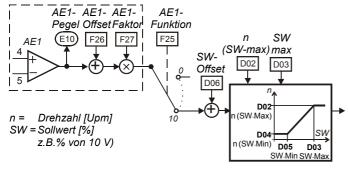
• D02: n (SW-Max) Drehzahl bei max. Sollwert
