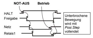
Mit Parameter I19=1 kann festgelegt werden, dass Freigabe-Aus zum Betriebszustand "23:unterbrochen" führt. Der unterbrochene Fahrsatz kann dann mit Posi. Step vollendet werden. In der Werkseinstellung (I19=0) führt die Wegnahme der Freigabe zum Reset der Ablaufsteuerung (Zustand "17:Posi.aktiv").
