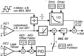
Alternativ zur Durchmesserberechnung **G11**=1:n-Leit/n-Motor kann bei einer Tänzerwalze auch **G11**=2:Tänzer eingesetzt werden. Die Abweichung des Tänzers wird über Analogeingang gemessen (**F20**=12:WicklerTänzer). Die Notwendigkeit einer Drehzahlrückführung entfällt, die Integration des Durchmessers wird durch die positive oder negative Abweichung des Tänzers gesteuert.
