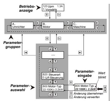
Nach dem Einschalten zeigt der Umrichter nur die wichtigsten Parameter an, die für eine Inbetriebnahme erforderlich sind. Für die Lösung komplexer Antriebsaufgaben wird mit **A10**=1 der *erweiterte Menü-Umfang* aktiviert.
