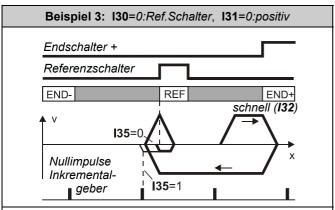
Der Referenzschalter (Nocke) spricht nur kurz an. Ein Endschalter dient der Reversierung.
