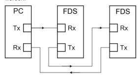
Die Vernetzung über einen RS232-Ring wird vom FDS-Tool unterstützt.
